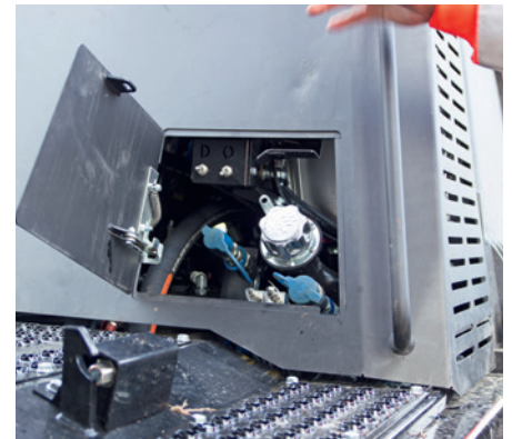
Polttoaineen ja hydraulioöljyn täyttö helposti koneen vierellä seisten.
