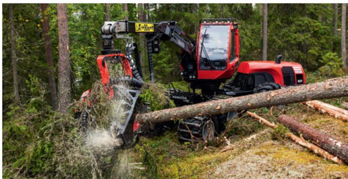
**O sistema de três bombas, 3PS, permite ao operador realizar diversas tarefas de trabalho ao mesmo tempo, uma vez que o fluxo disponível para as funções da máquina é maximizado e ajustado de acordo com as necessidades.**
