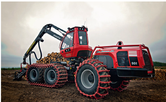
Bei der neuen Maschine sind das Bogie und die einzelnen Räder mit Bändern versehen.
