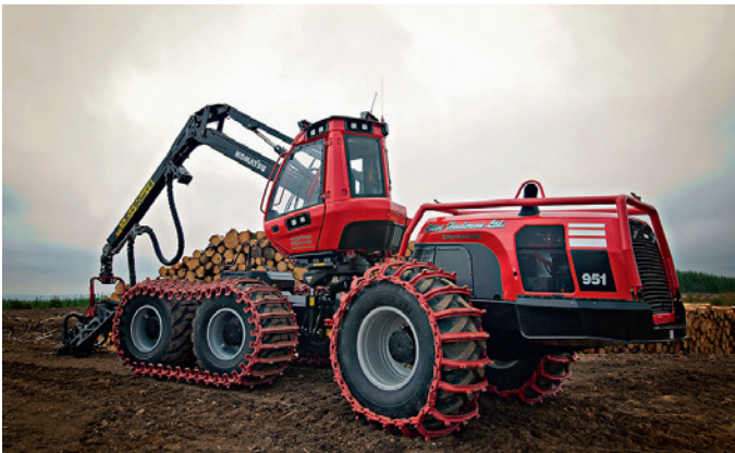
Uuteen koneeseen asennettiin telaketjut sekä teliin että molempiin takarenkaisiin.
