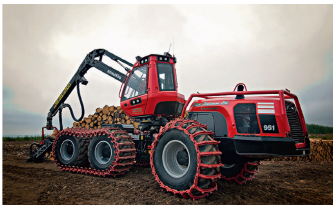
Den nya maskinen utrustades med band på boggin samt band på varje enskilt hjul.
