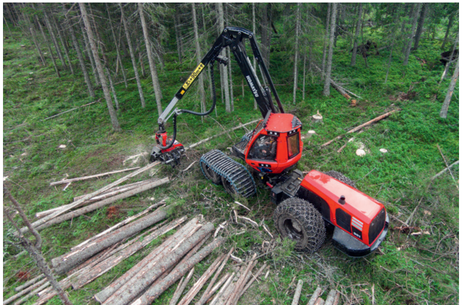
Härnö Skog använder sin Komatsu 951 i slutavverkning där medelstammen är extremt varierad.
