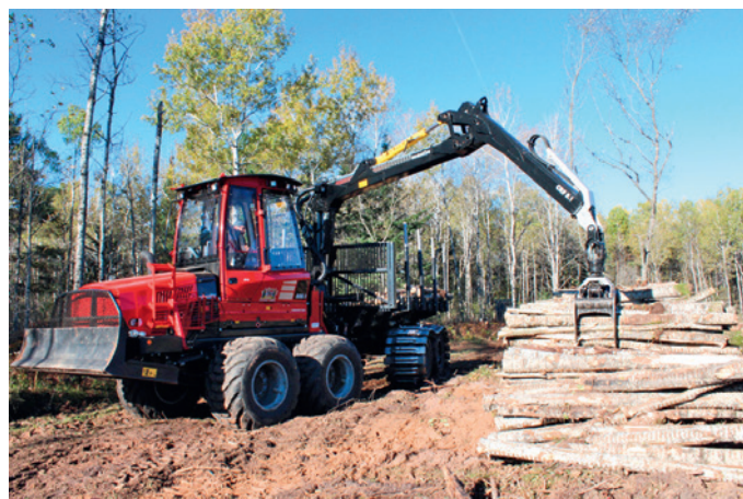
Larry Poquette operando o novo trator florestal Komatsu 855.1 equipado com o sistema de hidráulico de suspensão da cabine Comfort Ride.
