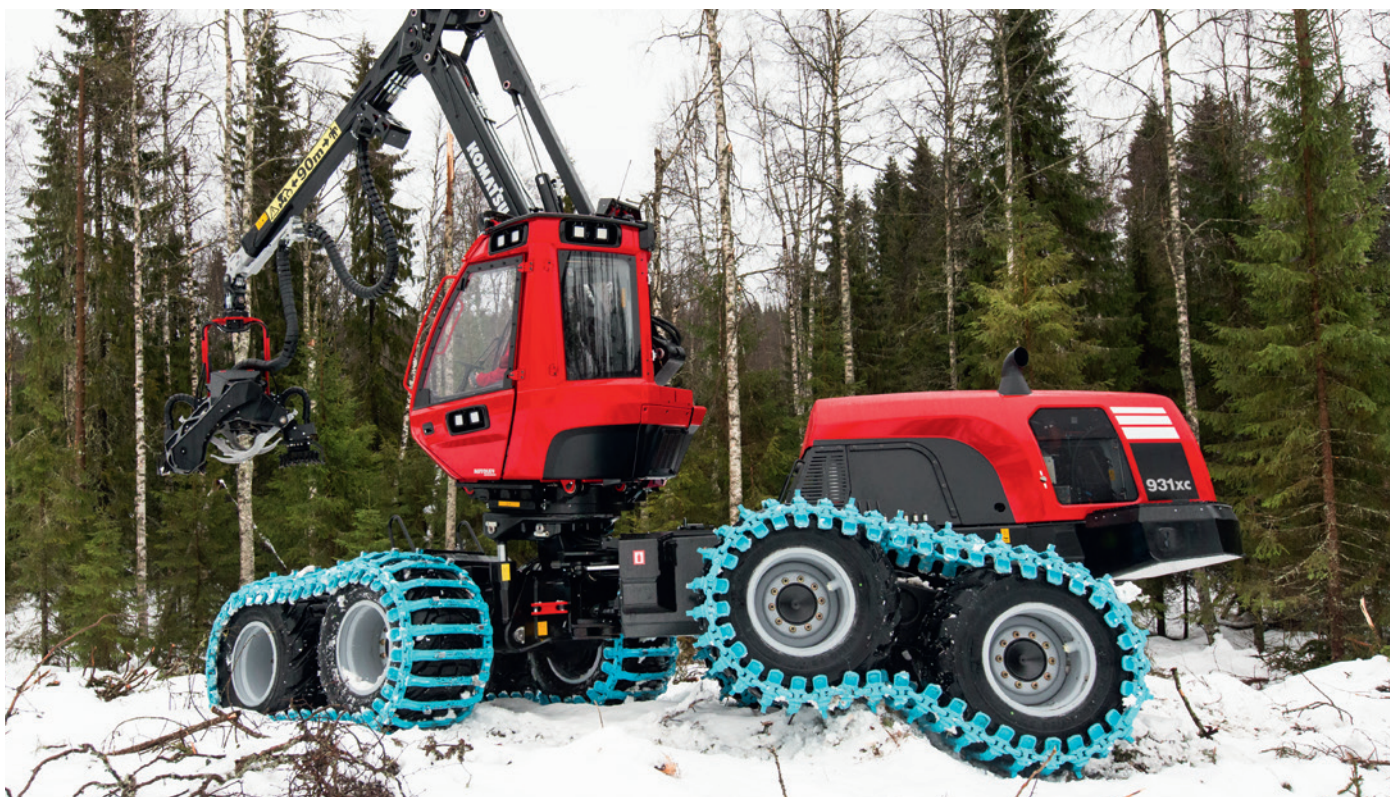
A suspensão dupla compreende uma junta rígida articulada e um eixo oscilante, combinados com um bogie montado no eixo oscilante. Oferece máxima mobilidade e conforto em ladeiras íngremes e solo macio.
