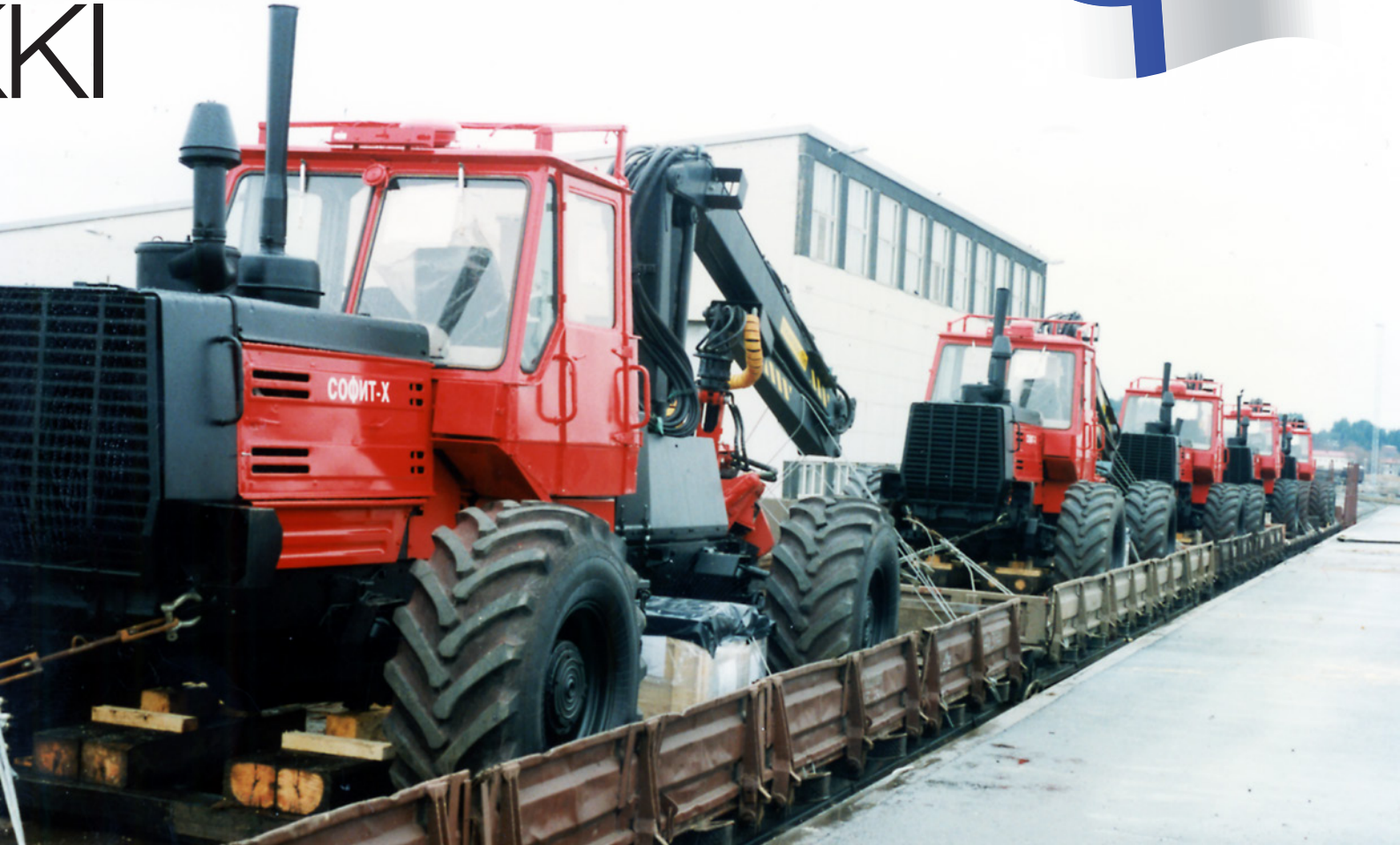
Eram as primeiras máquinas do projeto SOFIT prontas para serem enviadas aos clientes da Rússia. O transportador era da fábrica russa de tratores Harkov enquanto a grua e o sistema hidráulico eram fabricados na Suécia.
