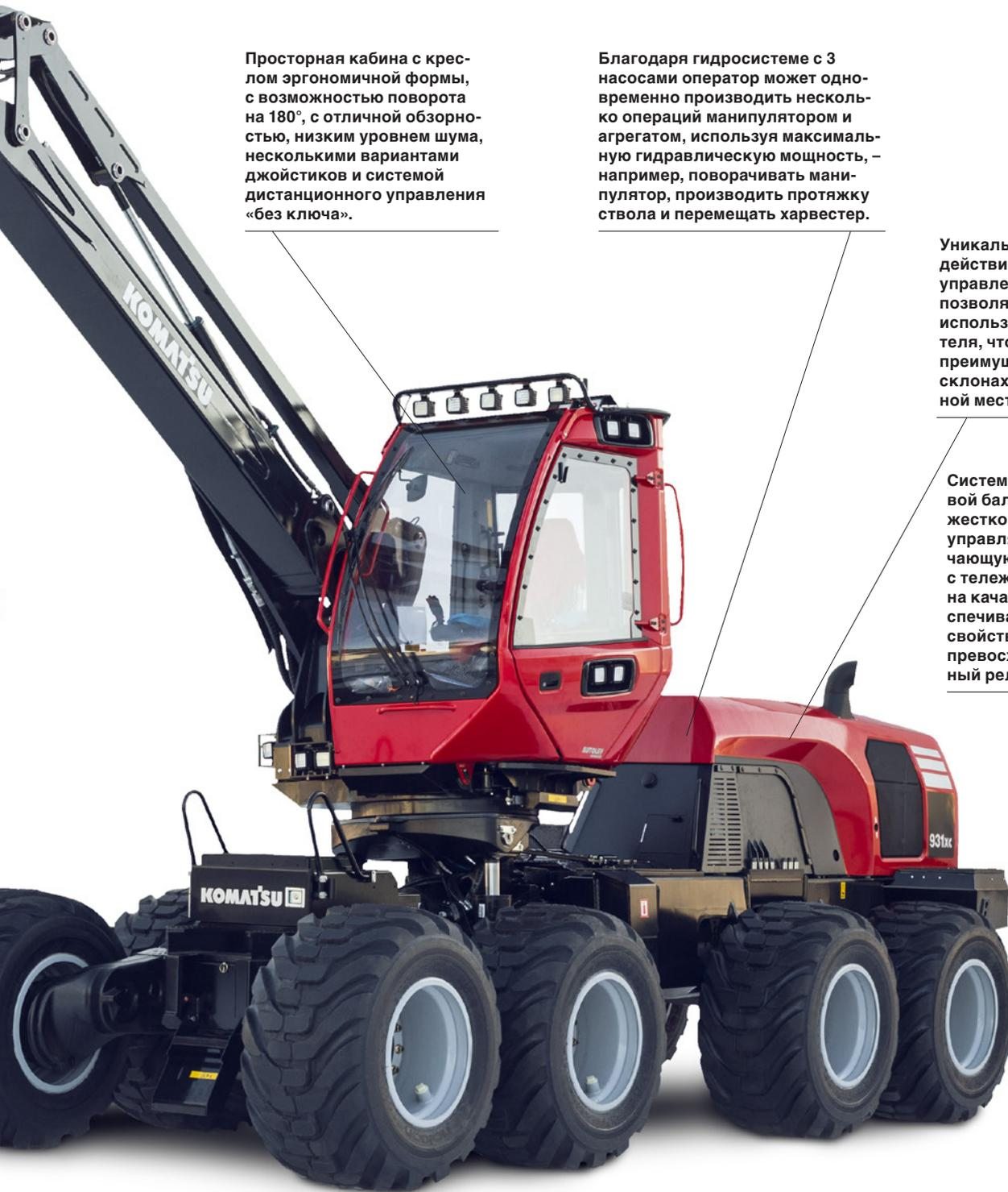
Просторная кабина с креслом эргономичной формы, с возможностью поворота на 180°, с отличной обзорностью, низким уровнем шума, несколькими вариантами джойстиков и системой дистанционного управления «без ключа».
