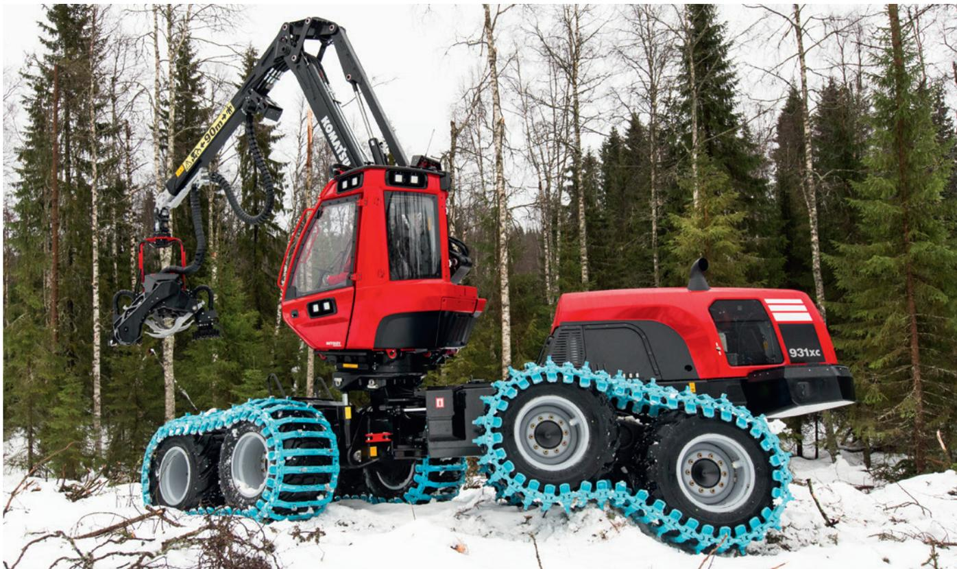
Система двойной маятниковой балансировки включает жестко фиксированный управляющий шарнир и качающуюся ось в комбинации с тележкой, смонтированной на качающейся оси. Обеспечивает максимальную проходимость и комфорт на склонах и мягких грунтах.
