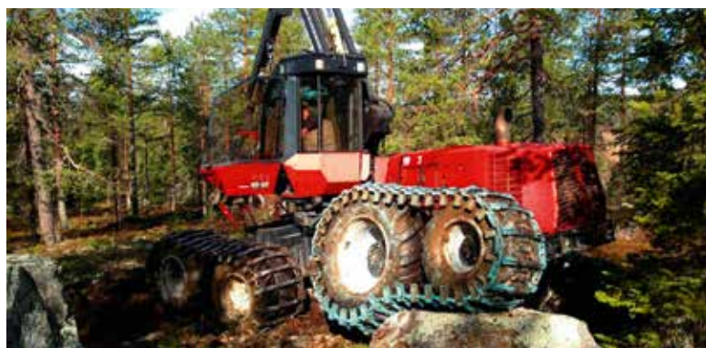
Las ruedas traseras adicionales y suspendidas proporcionaron buena movilidad.
