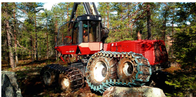
As rodas traseiras extras ajustáveis proporcionaram boa mobilidade.
