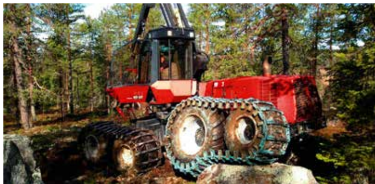
Подпружиненное дополнительное заднее колесо обеспечивает лучшую проходимость.
