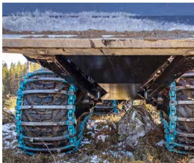
Портальные тележки обеспечивают оптимальный дорожный просвет и на форвардерах, и на харвестерах.
