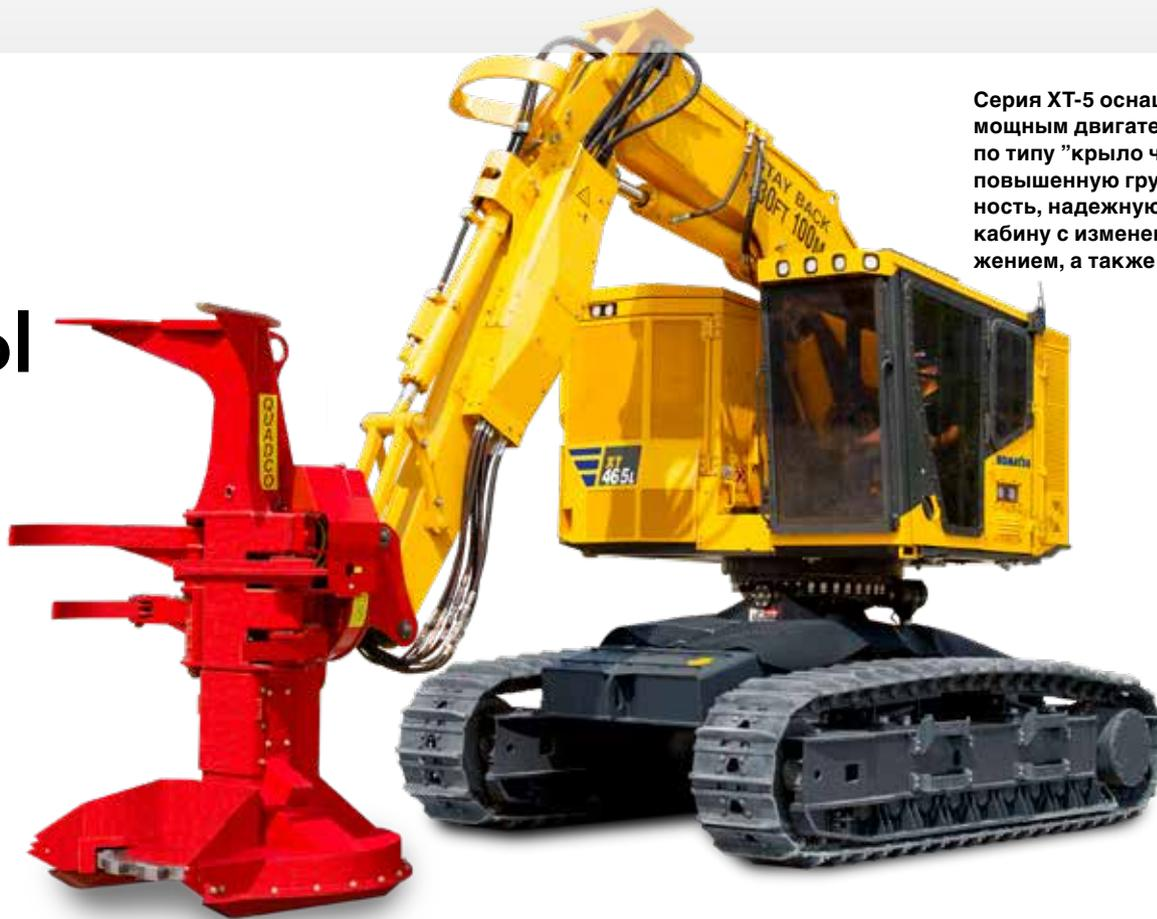
Серия XT-5 оснащена более мощным двигателем, капотом по типу "крыло чайки", имеет повышенную грузоподъемность, надежную опору шасси, кабину с измененным расположением, а также KOMTRAX\*.
