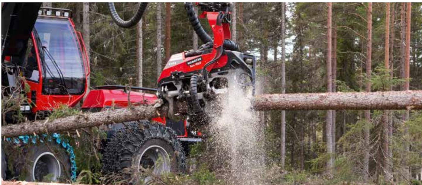
Смазываемая цепь, ECO-GLS, снижает негативное воздействие на окружающую среду. Доступна в качестве опции для Komatsu C93, C123, C124 и C144.
