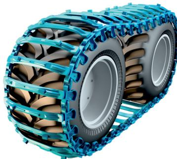
**OF** – ein Leichtes Band für steiles und steinigtes Gelände
